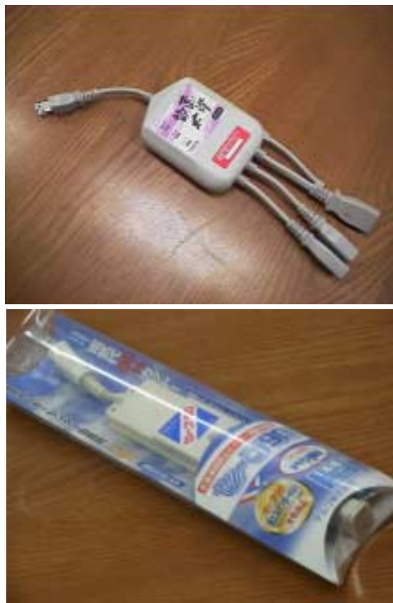
写真 1 水道凍結防止電熱線用節電装置
