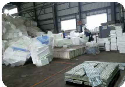
泉リサイクルセンターには、魚を入れる「魚箱」が山積み。手前が魚箱を熱で溶かした「インゴット」
